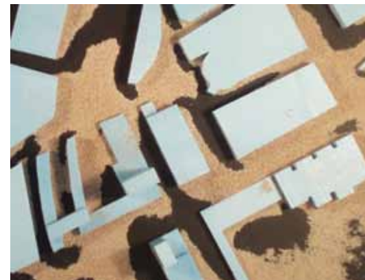
Erosionstest af bymiljø i vindtunnelen (Axeltorv, KBH). Illustration: Jakob Strømmand-Andersen
