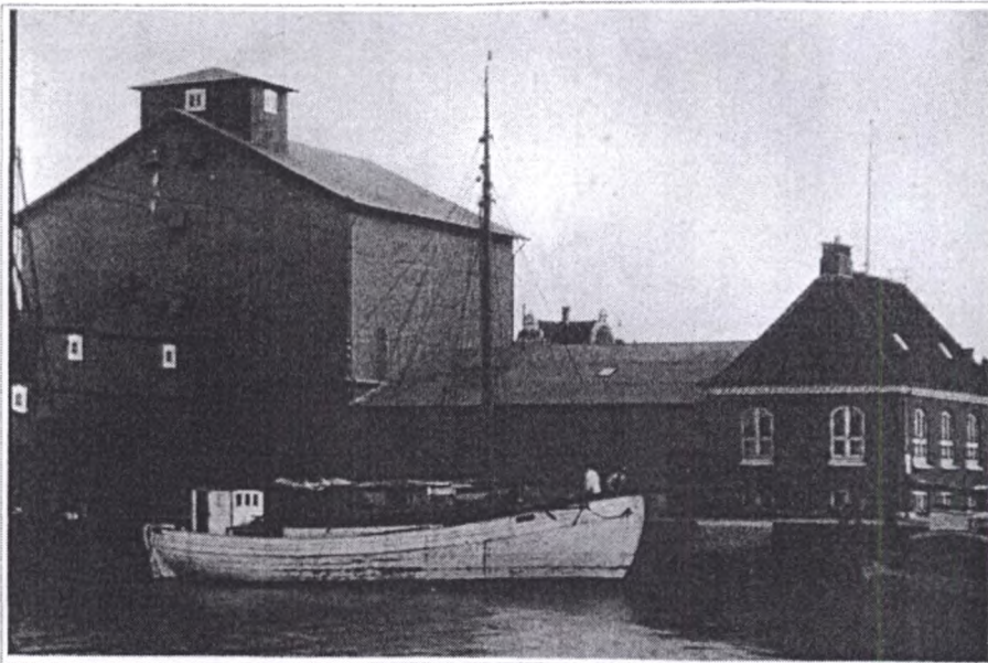
Motorsejler af den type som blev bygget efter ca. 1910. Sejlskibsrigning og linier er bevaret, men styrehuset viser den ny tid. Herunder: Coasteren "Andreas Boye. Det moderne fragtskib bygget i stål.
