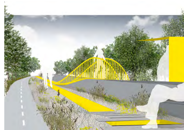
▲ Murens funktion. Muren varieres i højden, men er konstant i kote 3; i nord forsvinder den helt, hvor vejen ligger højt. Arealet er designet med aflange fortovsfliser, grus med beplantning og en dobbeltrettet cykelsti.
