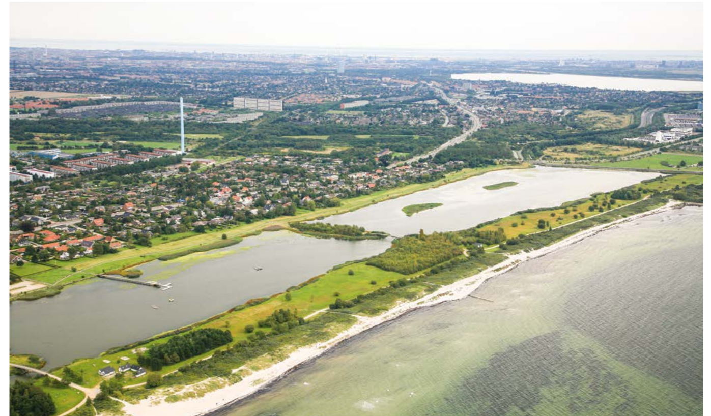
Køge Bugt Strandpark, hvor der er etableret et 7 km langt landskab af kystsikring og strandpark i Køge Bugt fra Brøndby til Hundige.
